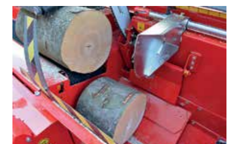
Mithilfe der Führungsplatten wird auch kurzes Holz kontrolliert in den Spaltkorb ausgestoßen.
