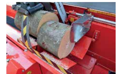
Mithilfe der Führungsplatten wird auch kurzes Holz kontrolliert in den Spaltkorb ausgestoßen.
