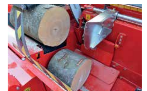
À l'aide des plaques de guidage, les troncs les plus courts tombent dans la tête de coupe d'une manière contrôlée.
