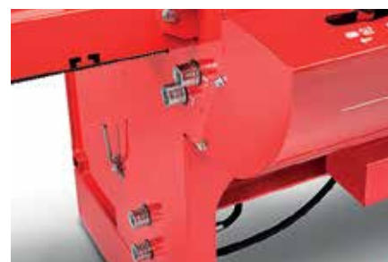
Hidrauliskās šļūtenes var viegli pieslēgt iekārtai ar ātrdarbīgiem savienotājiem, kas pieejami kā papildu piederums.
