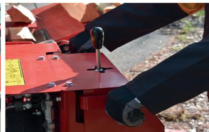
Простое управление с помощью рычажного управления, в котором раскол выполняется двумя руками..
