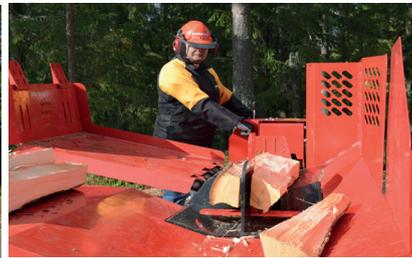
Благодаря гидравлической регулировке высоты, вы можете разделить бревно на две или четыре части, отрегулировав высоту разделительного ножа.
