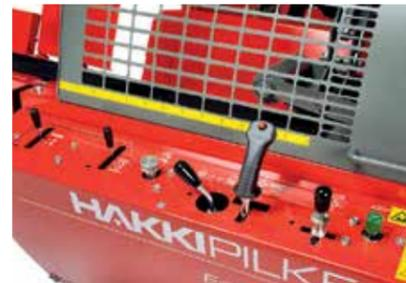
Sencillo panel de control en el que la entrada, el corte y el astillado se controlan con una sola palanca de mando.
