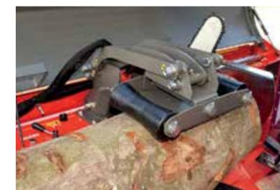
La presa de troncos hidráulica permite serrar sin esfuerzo troncos de todos los tamaños.
