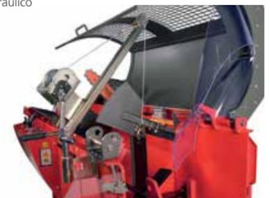
La sustitución de la cuchilla de astillado es rápida y segura gracias al cabrestante desmontable.
