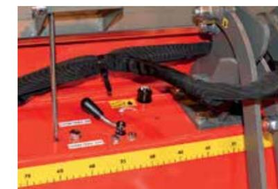
El tensor de cadena automático AC 10 mantiene una tensión óptima de la cadena de sierra en todo momento. La cadena puede sustituirse cómodamente tras liberar la tensión de la cadena con la palanca de la imagen. ¡No hacen falta herramientas!
