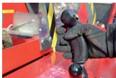
Control eléctrico de serrado y astillado con solo dos botones.
