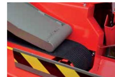
Alimentación de troncos utilizando una resistente cinta con una superficie rugosa.
