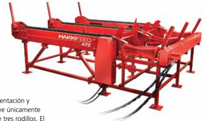
La mesa para troncos HakkiFeed 472 incluye tres cadenas de alimentación y separadores mecánicos, lo que asegura que la alimentadora mueva únicamente un tronco cada vez hacia el mecanismo de transferencia lateral de tres rodillos. El mecanismo de transferencia lateral está sincronizado con la cinta transportadora de alimentación de la procesadora de leña, lo que asegura que se mueven hasta los troncos más robustos hacia el dispositivo de corte de la procesadora.
