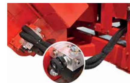
간편 설치 부속품으로 배출 컨베이어 속도 제어 밸브가 있습니다.
