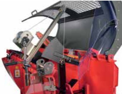
Lama de despicat se înlocuiește rapid și în siguranță datorită trolului detașabil.
