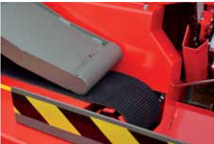
Încărcarea buștenilor cu o curea rezistentă, cu suprafață rugoasă.
