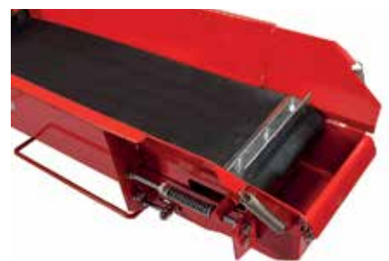
Transportorul brevetat de evacuare cu curățitor inclus în varianta standard. Canalul de la capătul transportorului de evacuare separă resturile de lemnul de foc.
