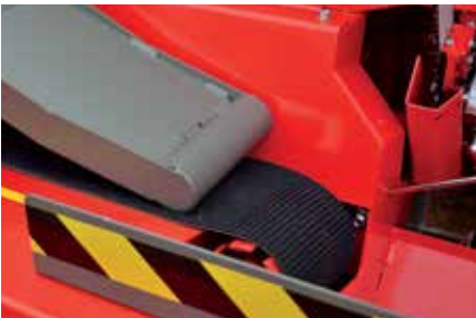
Podávanie guľatiny pomocou pevného pásu s drážkovaním.
