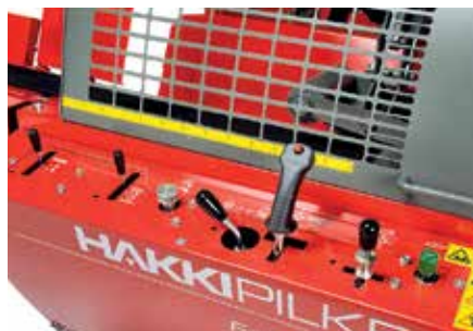
Jednoduchý ovládací panel pre privádzanie, rezanie a štiepanie, ovládanie je riešené jedným pákovým ovládačom.
