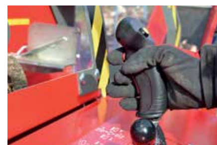
Elektrické ovládanie rezania a štiepania len dvomi tlačidlami.
