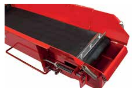
Patentovaný samočistiaci dopravník ako štandard. Drážka na konci výstupného dopravníka oddeľuje úlomky od palivového dreva.
