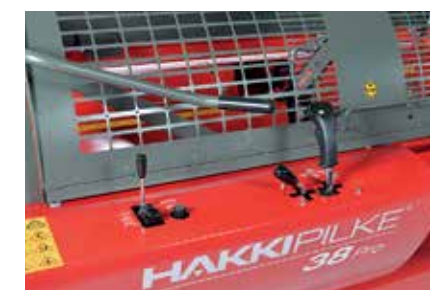
Ergonomický a jednoduchý riadiaci panel obsahuje všetky potrebné riadiace prvky k obsluhu stroja.
