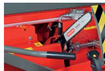
Súbežné ovládanie AC10 a elektrickej píly umožňuje rýchlu a nepretržitú prevádzku.
