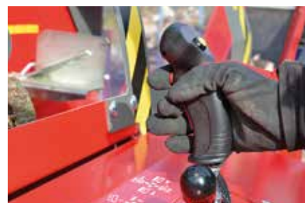
Elektriline saagimise ja lõhkumise juhtimine üksnes kahe nupuga.
