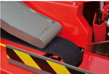
Palkide edastuseks kasutatakse tugevat kareda pinnaga linti.
