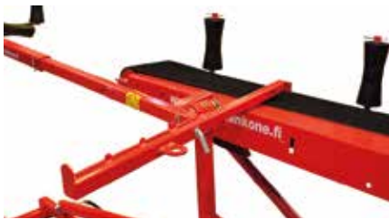
Transporditugi tõmmatakse raamist välja üle etteveokonveieri.
