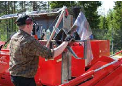
Lõhkumistera vahetamine on kiire ja ohutu tänu eemaldatavale vintsile.
