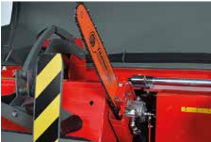
50 Pro on varustatud patenteeritud AC 10 automaatse ketipingutiga. Õige ketipingsus pikendab märkimisväärselt keti ja saeplaadi tööiga.
