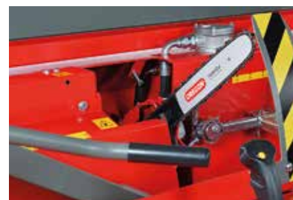
AC 10 ja elektriline sae juhtimissüsteem tagavad kiire ja katkematu töö.
