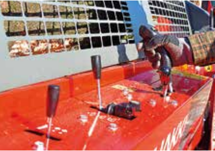
Lihtne juhtpaneel, kus ettevedu, lõikamist ja lõhkumist juhitakse üheainsa juhthoovaga.
