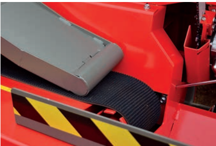
Il nastro di alimentazione è in gomma robusta e ruvida.
