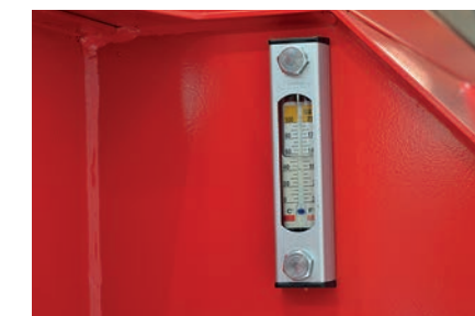
Serbatoio olio con grande capacità e Spia di livello
