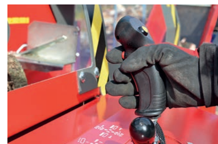
Controllo elettrico di taglio e spacco con 2 pulsanti.
