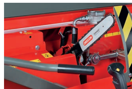
Insieme, l'AC10 e la sega elettrica hanno una grande capacità del serbatoio dell'olio e un vetro spia. Il controllo assicura di operare in modo veloce e ininterrotto.
