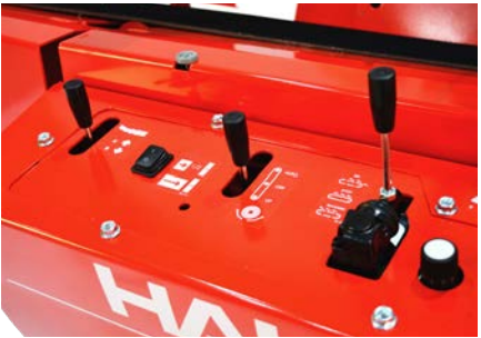
Il Sistema HakkiSplit ™ ha una funzione di mezzo per rendere più veloce il processo di spacco della legna da ardere corta. Lo spacco a metà corsa può essere facilmente controllato con un pulsante nel pannello anteriore.
