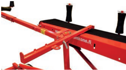
Il supporto di trasporto viene estratto dal braccio e messo sopra il trasportatore di alimentazione.
