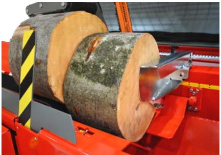
Le piastre guida tronco assicurano che anche i tronchi tagliati più corti atterrino ordinatamente nella vasca di spacco.
