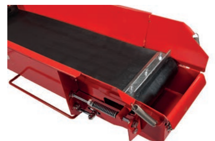
Trasportatore di scarico pulizia brevettato come standard. Lo spazio alla fine del trasportatore di uscita separa i detriti dalla legna da ardere.
