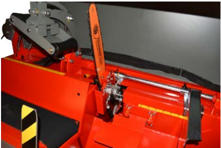
50 PRO è equipaggiata con tenditore automatico della catena brevettato AC10. La corretta tensione della catena permette sempre un taglio efficace e più durata delle catene e barre di taglio.
