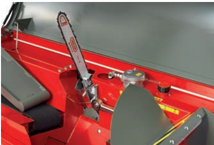
Эффективная гидравлическая пила.
