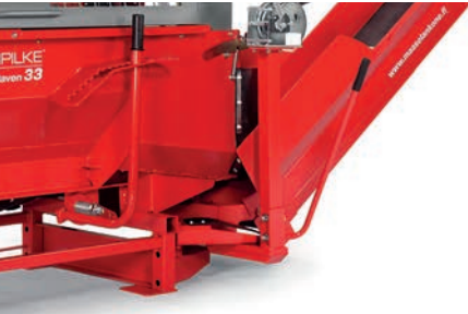
Гидравлический вращающийся разгрузочный конвейер в стандартной комплектации.
