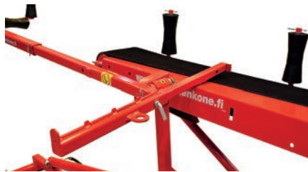
Транспортная опора вынимается из стойки и перекладывается через загрузочный конвейер.
