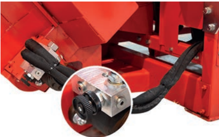
Клапан, регулирующий скорость разгрузочного конвейера, как опция.
