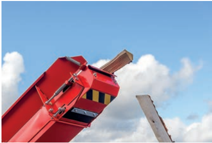
Система очистки разгрузочного конвейера отделяет отходы, повышая чистоту конечного продукта.
