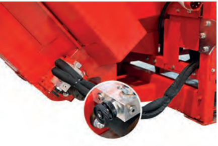
Snadná instalace rychlostního ventilu vkladacího dopravníku.
