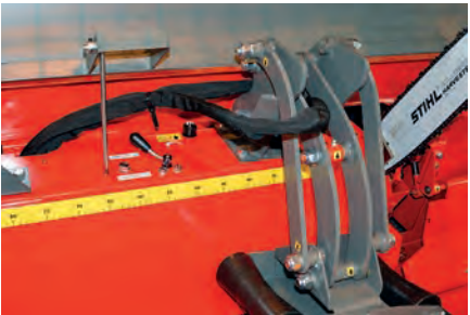
Hydraulický přidržovač kmene umožňuje snadné řezání polen všech velikostí.
