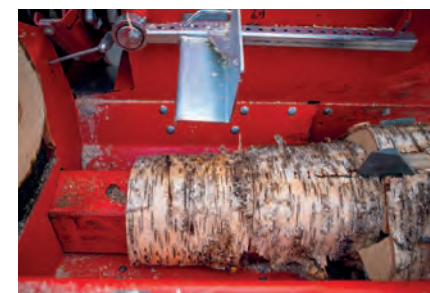
38 Pro má funkci polovičního štipnutí, která urychluje štipání krátkého palivového dřeva. Funkci polovičního štipání lze snadno ovládat tlačítkem na předním panelu.
