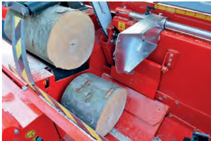
Díky tvaru žlábků je zajištěn správný dopad i toho nejkratšího špalku pro následné štípání.
