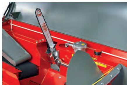
Efektivní, hydraulicky poháněná lišta.
