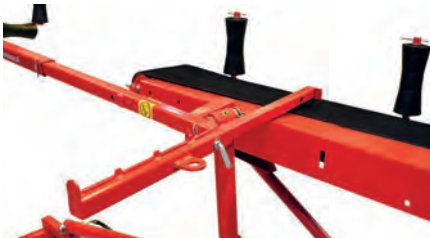
Převrtní závěs se vytáhne z ramene přes vkladací dopravník.
