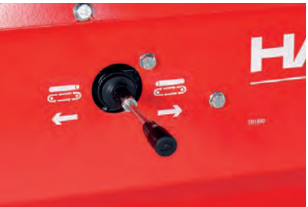
Zpětný ventil vkladacího dopravníku ve standardní výbavě.
