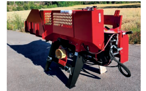
Hakki Pilke HH 110 OH hydraulihalkoja omalla hydraulilla, jonka suositeltu tuotto on 400 r/min, 37 l/min.
