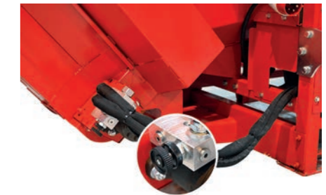
Poistokuljettimen nopeudensäätöventtiili helposti asennettavana lisävarusteena.
