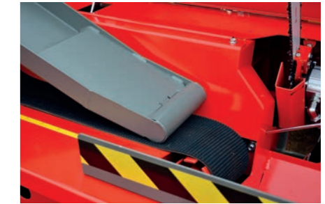
Puunsyöttö karheapintaisella ja raskastakin käyttöä kestäväällä matolla.
