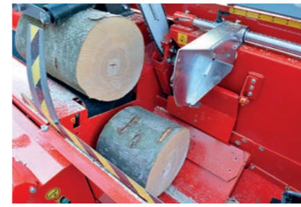
Ohjauslevyjen avulla lyhyimmätkin puut putoavat hallitusti halkaisukouruun.
