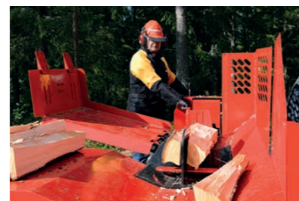
Hydraulisella korkeudensäädön ansiosta, halkaisuterän korkeutta säätämällä voit halkaista puun kahteen tai neljään osaan.
