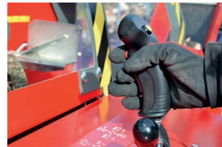
Sahausten ja halkaisun sähköinen ohjaus vain kahdella napilla.
