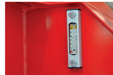
Suuri öljysäiliön tilavuus ja mittalasi.
