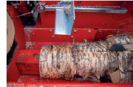
38 Pro:ssa on puoli-isku toiminto, joka tekee lyhyitä polttopuita nopeasti. Puoli-isku toimintoa voidaan hallita helposti painikkeella etupaneelistä.
