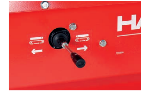
Vakiovarusteena syöttökuljettimen peruutusventtiili.
