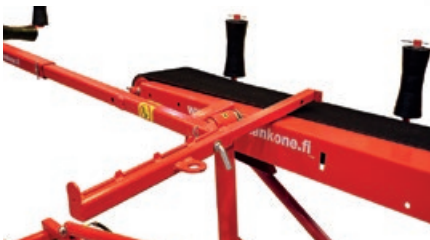
Der Transportträger wird aus dem Ausleger und über den Vorschubförderer gezogen.
