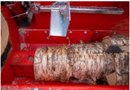
Die Halbhubfunktion des 38 Pro beschleunigt den Spaltvorgang von Kurzholz. Die Halbhubfunktion lässt sich bequem über eine Taste am Bedienfeld steuern.
