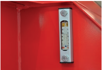
Öltank mit großer Kapazität und schauglas.
