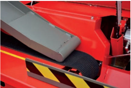
Stammvorschub durch Schwerlastband mit rauer Oberfläche.
