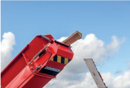
Le convoyeur de sortie nettoyant sépare les débris pour procurer du bois à brûler plus propre.
