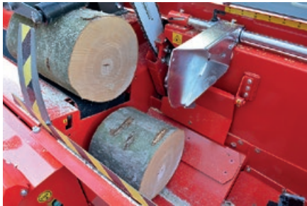
Les plaques de réception de bûches permettent que même les bûches coupées au plus court atterrissent exactement dans la rainure de fendage.
