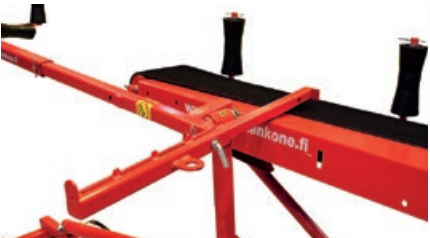
Le support de transport se déploie depuis le bras par dessus le convoyeur d’entrée.
