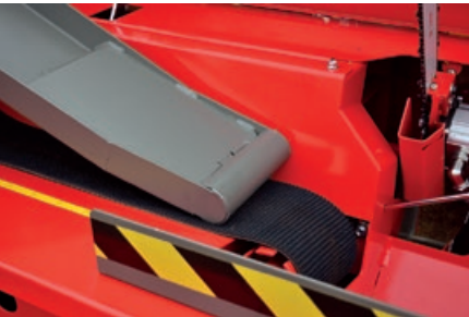
Alimentation de bûches via une courroie ultra-résistante à surface rugueuse.
