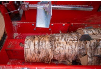
38 Pro a une fonction demi-course pour rendant le processus de fractionnement de court bois de chauffage plus rapidement. Le fractionnement en demi-course peut être facilement contrôlé avec un bouton dans le panneau avant.
