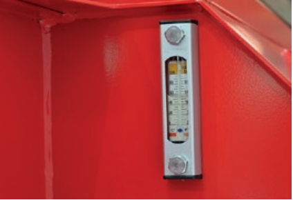
Grande capacité du réservoir d'huile et regard.
