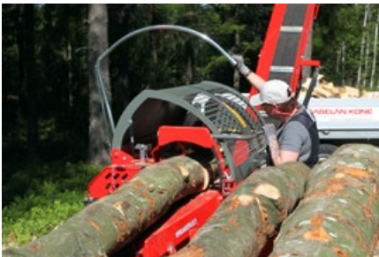
L'hydraulique à entraînement direct de la machine active les fonctions simultanées avec mouvements sans effort du levier de commande.
