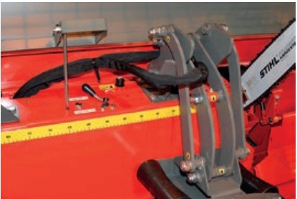
Le tendeur de chaîne automatique AC 10 maintient en permanence la tension optimum de la chaîne coupante. La chaîne peut être aisément remplacée après avoir libéré la tension de chaîne avec le levier illustré – aucun outil requis !
