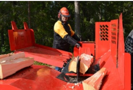
En modifiant la hauteur de la lame de coupe, il est possible de fendre la bûche en deux ou quatre morceaux.
