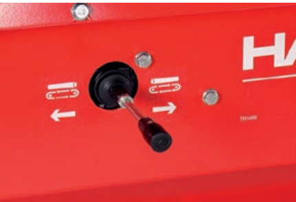
Backventil till inmatningstransportören som standard.
