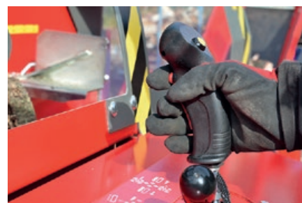
Elektrisk kontroll av kapning och klyvning med bara två knappar.
