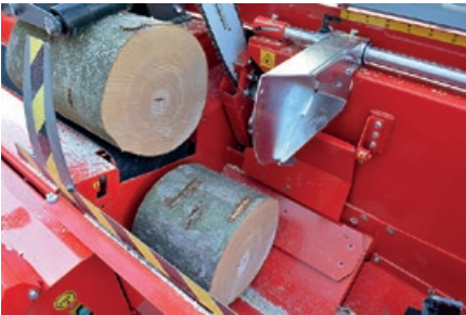
Med hjälp av styrplattorna faller också de kortaste vedklabbarna kontrollerat ned i klyvrännan.
