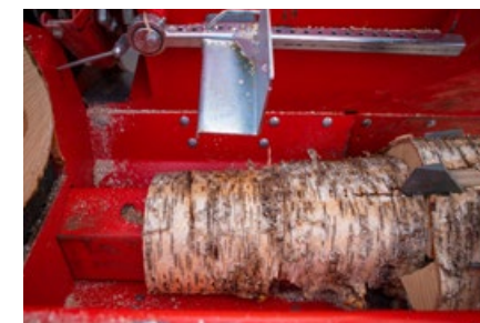
38 Pro har halvslagsfunktion gör klyvningsprocessen av kort ved snabbare. Halvslagsfunktionen kan enkelt styras med en knapp på kontrollpanelen.
