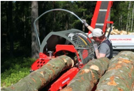
Maskinens direktdrivna hydraulik möjliggör drift av flera funktioner samtidigt med den smidiga manöverspaken.
