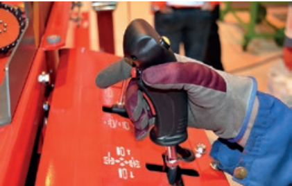
Optimerade funktioner som gör att du kan bearbeta ved med bara två knappar utan att röra joysticken.
