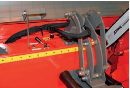
Den automatiska kedjespännaren AC10 upprätthåller hela tiden optimal sågkedjespänning. Kedjan kan enkelt bytas efter att kedjespänningen har släppts med spaken, som visas på bilden – inga verktyg behövs!
