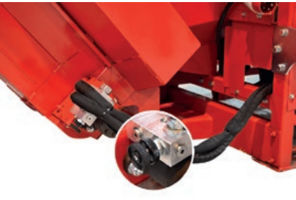
Som tillbehör finns en ventil som gör hastigheten på utmatningstransportören ställbar
