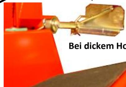
5. Sie stellen den Spaltkeil mit dem Einstellhebel entsprechend dem Holzdurchmesser auf die gewünschte Höhe ein.
