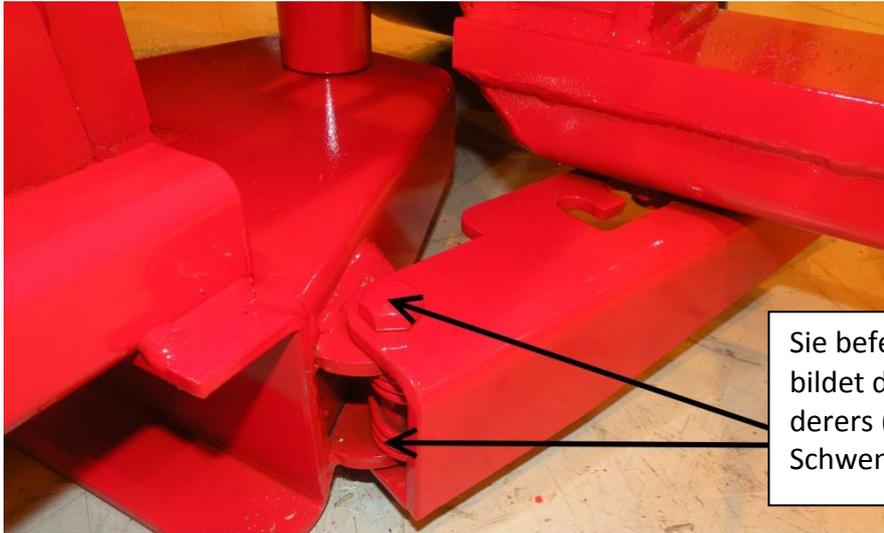
Sie befestigen wie nebenan abgebildet den Schwenkgriff des Förderers (Nr. 12 in Abb. 2) mit der Schwenkfeder.
