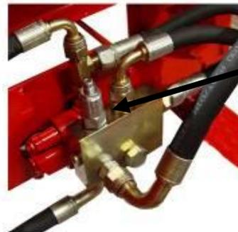
3. Sie öffnen die Verschlussmutter für die Druckverstellung des Geschwindigkeitsventils.
