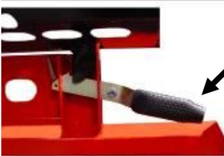
3. Sie heben das Schutzgitter des Zuführbandes an und stellen sicher, dass das Gitter in der oberen Stellung einrastet.
