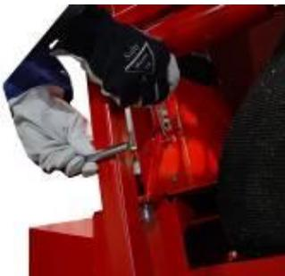
1. Sie entfernen den Splint im Verriegelungsgriff
