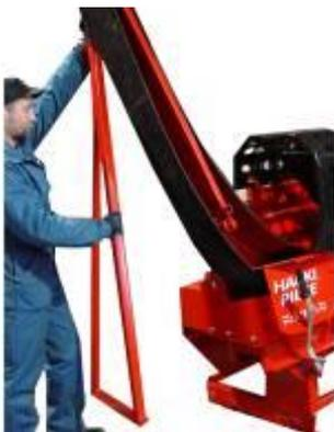
3. Sie kippen den Förderer nach unten in die waagrechte Stellung und stecken die Stütze in die Ösen im Unterteil des Rahmens.
