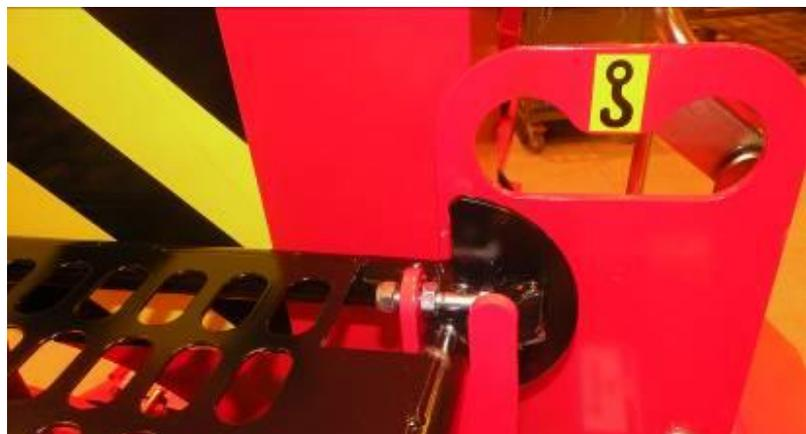
Abb. 4. Hebestellen für Kette oder Hebegurt
