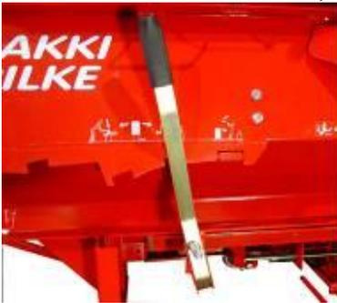
1. Sie bringen den Steuerhebel für das Sägen in die Stellung STOPP.
