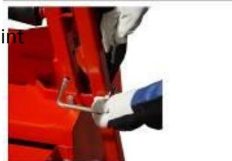
2. Sie entfernen den Verriegelungsgriff der Stütze
