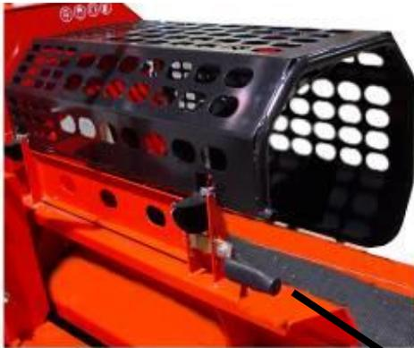
Stellen Sie beim Öffnen des Schutzgitters sicher, dass der Verschlussgriff den Schutz nach oben verriegelt!
