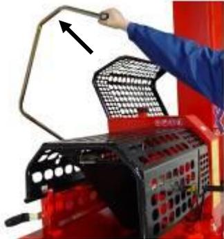
Das Zuführband transportiert das Holz, wenn der Sägehebel nach oben in die Grundstellung gebracht wird. Achtung! Beim Easy-Modell geschieht das gleiche, wenn der Steuerhebel B (Abb. 20) in die Stellung oben/rechts gedreht wird.
