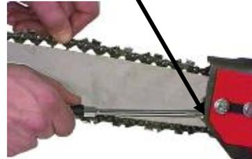
7. Sie ersetzen die stumpfe Kette durch eine neue und montieren alles in umgekehrter Reihenfolge oder schärfen die Kette durch Feilen in einem Schraubstock oder mit einem dazu geeigneten Schärfergerät.
