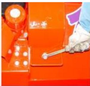
4. Sie öffnen die Schutzhaube der Sägekette mit einem Gabelschlüssel.
