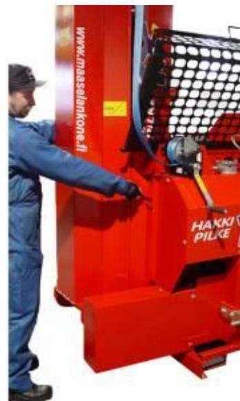
2. Sie drücken den Förderer gegen die Maschine und öffnen die Verriegelung durch Anheben des Verriegelungsgriffs
