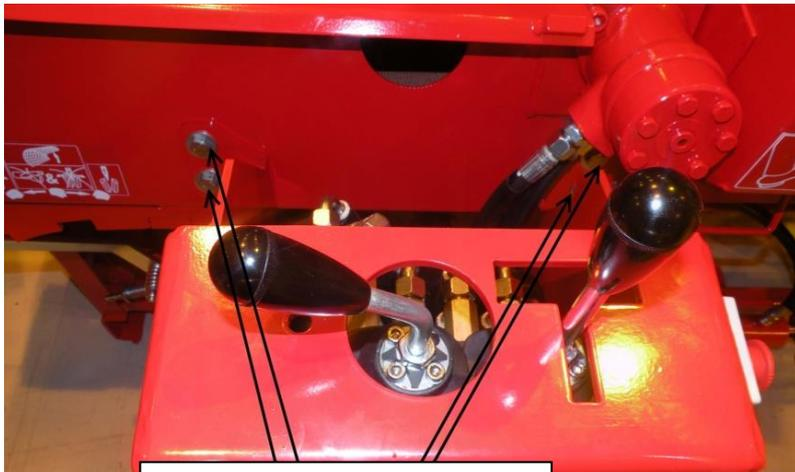
Sie heben das Steuerpult an die richtige Stelle und befestigen es mit vier Schrauben.
