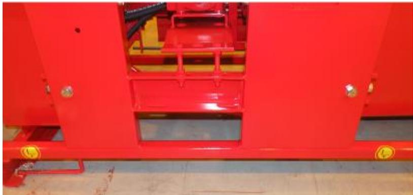
Abb. 3. Hebestellen für einen Gabelstapler
