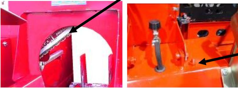
Wenn die Kette nicht ganz nach oben gelangt, dann spannen Sie die Feder, die das Kettenschwert nach oben zieht, mit der Einstellmutter an. Wenn die Einstellung nicht ausreicht, muss die Feder erneuert werden.
