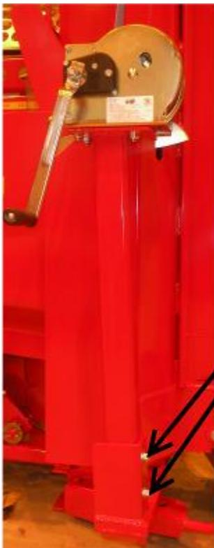
Sie montieren den Windenfuß und die Winde (Nr. 11 in Abb. 2) in die Ösen und ziehen die Bolzen (2 St.) an.
