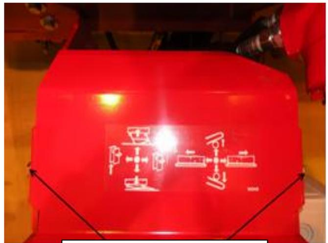
Sie befestigen die Schutzplatte für das Ventil wie abgebildet mit zwei Schrauben am Steuerpult.
