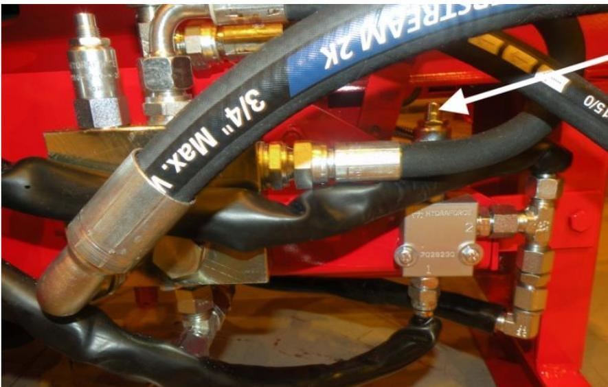
Druckeinstellventil für die Absenkbewegung des Sägeschwerts. Der Druck steigt durch Zudrehen der Innensechskantschraube und erniedrigt sich durch Aufdrehen. Für die Einstellung gibt es keine gesonderte Sollwerte, sondern der Bediener stellt bei Bedarf den passenden Druck ein.
