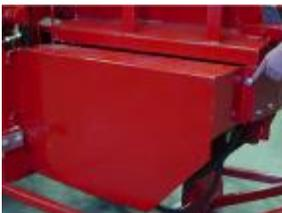
1. Sie öffnen die Verriegelung des Ventilschutzes.
