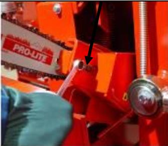
2. Sie spannen die Kette mit der Einstellschraube auf die richtige Spannung. Die richtige Spannung ist erreicht, wenn beim Herausziehen aus der Nut einer der Unterzähne vollkommen zu sehen ist.
