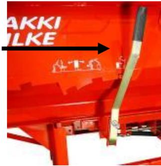
**WICHTIG!** Wenn sich der Bedienhebel für das Spalten in der Position BETRIEB befindet und das Schutzgitter geöffnet werden kann, dann ist das Benutzen der Maschine strengstens verboten. Eine defekte Verriegelung ist unbedingt zu reparieren. Das Schutzgitter für den Spaltbereich darf nur dann geöffnet werden können, wenn sich der Steuerhebel für das Spalten in der Position STOPP befindet.
