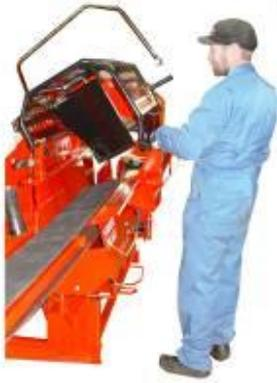
Stellen Sie sicher, dass das Schutzgitter für das Zuführband in der oberen Stellung auch einrastet!
