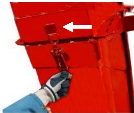
7. Sie stellen den Förderer mit der Winde auf die gewünschte Neigung ein und verriegeln die Verlängerung auf der Rückseite des Förderers mit dem Schnappschloss und dem Klappsplint.
