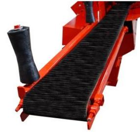
Vous pouvez redresser la courroie si elle a tendance à dévier à l'aide de l'écrou de réglage du côté vers lequel la courroie dévie.
