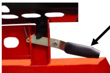
3. Lever de couvercle de protection du convoyeur d'alimentation et vous assurer qu'il est verrouillé dans sa position supérieure.
