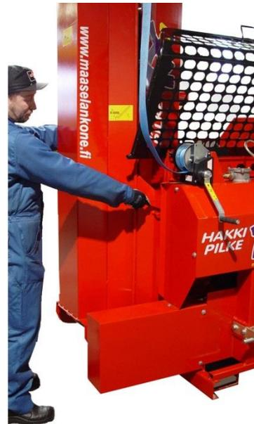
2. Poussez le convoyeur vers la machine et débloquez le verrouillage du convoyeur en relevant l'étrier de verrouillage.
