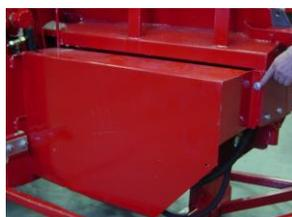
1. Enlevez le boulon de verrouillage du capot de la soupape.
