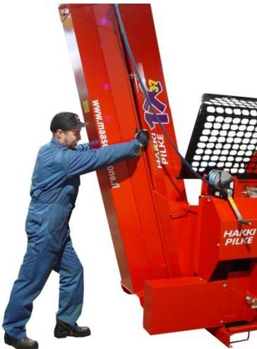
3. Tirez le convoyeur jusqu'à ce que le fil du treuil se tende.
