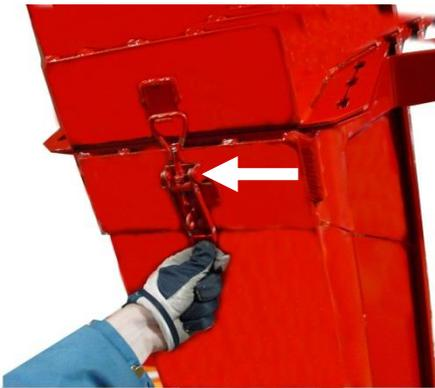
7. Ajustez le convoyeur avec le treuil à l'inclinaison désirée et bloquez-le avec le verrouillage situé dans la partie inférieure du convoyeur.
