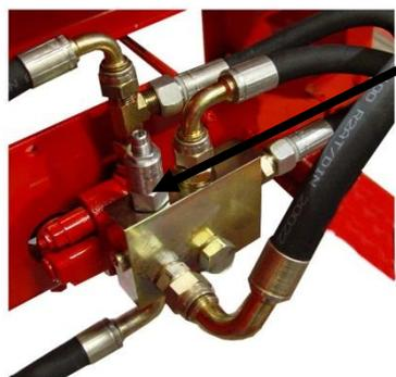
3. Ouvrez l'écrou de blocage du boulon de réglage de la pression de la soupape d'accélération.
