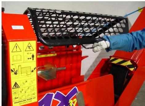
2. Ouvrir le couvercle de protection de la rainure du guide de coupe.
