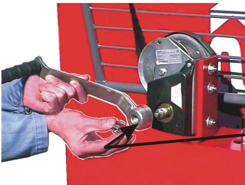
Mettez en place la poignée de commande du treuil du convoyeur et verrouillez-la à l'aide d'un écrou. **N.B. : Ne serrez pas l'écrou! Laissez un espace de 3 mm entre le bras de manivelle et l'écrou!**
