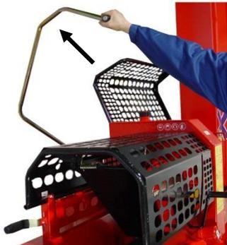
Le convoyeur d'alimentation commence à transporter le bois dès que le levier de commande de la tronçonneuse est relevé par rapport à sa position initiale
