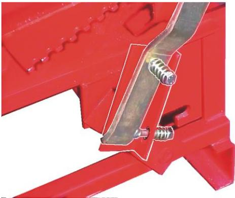
Fixez le levier de réglage vertical de la lame de fendage comme le montre l'illustration. Placez le ressort, qui maintient le levier dans sa fente de réglage à l'extérieur sous la tête du boulon. Placez sous l'écrou le ressort permettant à la lame de se mouvoir. Le boulon et l'écrou sont correctement serrés lorsque le ressort commence à se tendre.
