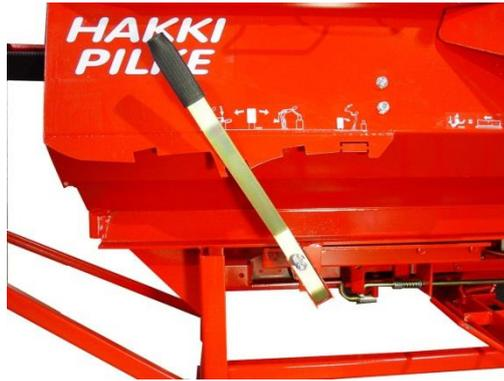
3. Abaissez le levier de commande de la tronçonneuse et laissez-le reprendre sa position initiale
