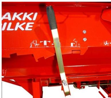
1. Mettre le levier de commande de coupe en position d'arrêt.
