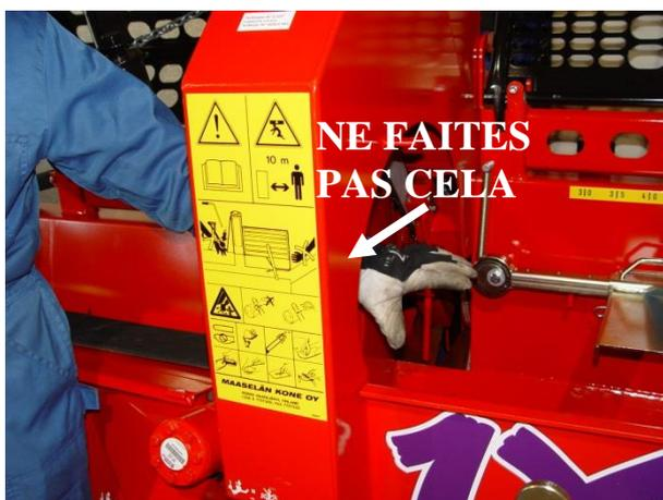
**NE PLAZES JAMAIS VOTRE MAIN DANS L'OUVERTURE DE COUPE LORSQUE LA MACHINE FONCTIONNE. TOUJOURS ARRÊTER MACHINE POUR L'ENTRETIEN**
