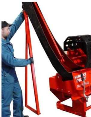
3. Mettez le convoyeur en position horizontale et placez le support du convoyeur dans les fentes à la partie inférieure du châssis.
