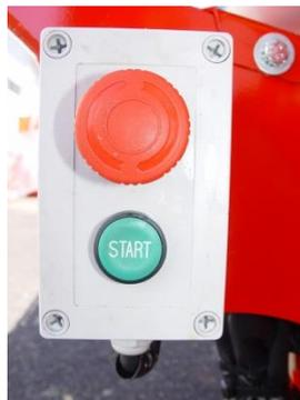
Le boîtier de mise en marche est situé sur la droite des leviers. Le bouton de mise en marche de la machine est le bouton vert dans le boîtier de mise en marche. Le bouton rouge dans le boîtier de mise en marche est le bouton d'arrêt de la machine. **NB ! Le bouton doit être dans sa position haute pour que la machine puisse être capable de démarrer.** Pour pouvoir mettre le bouton dans sa position haute, il faut légèrement le faire tourner dans le sens des aiguilles d'une montre.
