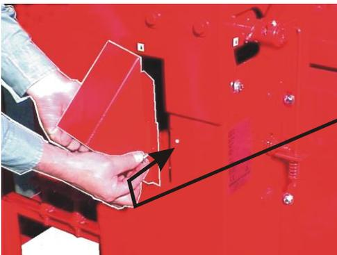
Fixez au châssis de la machine le capot anti-sciure de la tronçonneuse au moyen de deux boulons serrés avec une clé.
