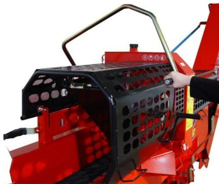
4. Assurez-vous que le tube de fendage se rapproche de la lame de fendage et revient après cela à sa position initiale, c'est-à-dire, que le mouvement de fendage fonctionne correctement.
