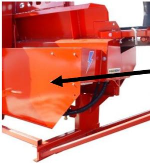
Le boîtier de mise en marche est situé derrière la plaque de protection à l'arrière de la machine.
