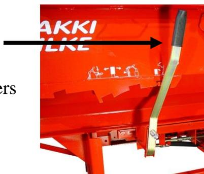
Il est possible d'ouvrir le capot de la goulotte de fendage lorsque le levier de fendage est en position STOP.
