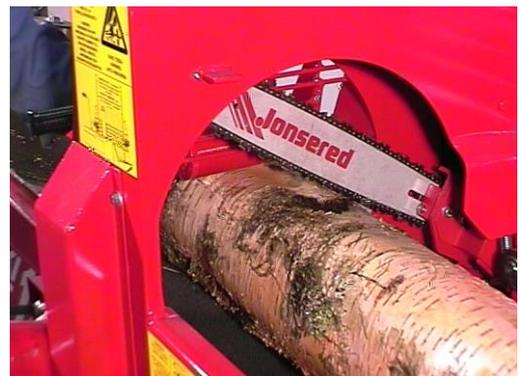
Si la bûche est de biais, il est probable qu'elle entrera en contact de biais avec la lame de fendage et restera coincée. Dans un tel cas, suivez la procédure suivante :
