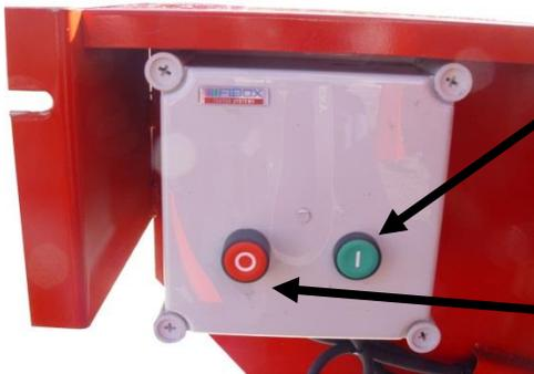
La machine ne peut pas être mise en marche en pressant le bouton vert si le bouton sur le devant de la machine n'est pas en position haute.
