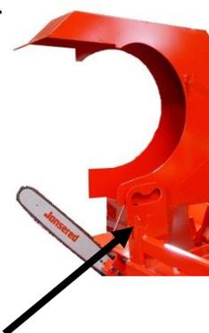
5. Tourner la protection d'ouverture de la lame vers l'arrière.
