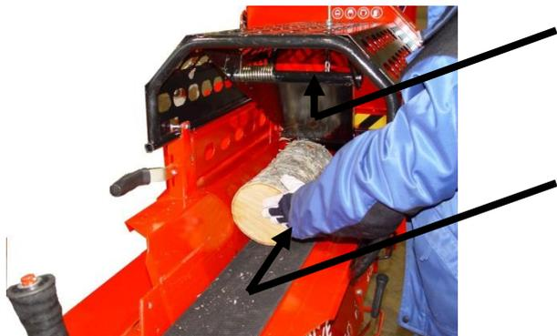
Soulevez le capot de l'ouverture de coupe de plus ou moins 5 cm mesurés à partir de la surface du bois et enfoncez le bois dans la goulotte d'alimentation du fendeur d'un petit mouvement de main rapide. **N'INTRODUISEZ JAMAIS LA MAIN AU-DELÀ DU NIVEAU DU ROULEAU DE SUPPORT!**
