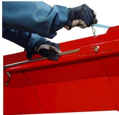
9. Poussez le support de la courroie du côté du convoyeur.
