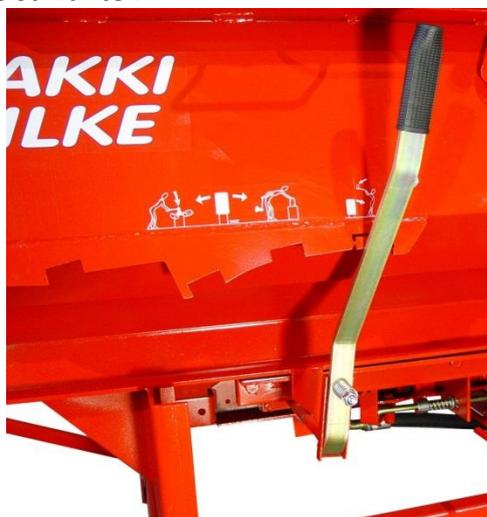
3. Dès que le piston de fendage est revenu en position initiale, placez le levier de fendage en position STOP SPLITTING (ARRETER LE FENDAGE).
