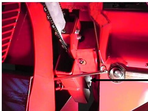
L'axe d'entraînement de la tronçonneuse
