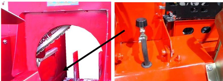
Si la tronçonneuse n'est pas complètement soulevée, resserrez le ressort qui repousse le guide de la scie avec son écrou de réglage. Si la réserve de réglage est insuffisante, remplacez le ressort.
