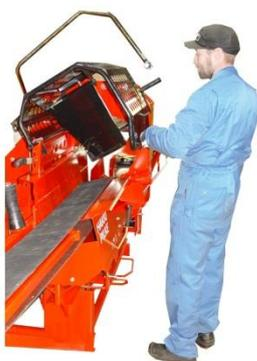
Vous assurer que le couvercle de protection du convoyeur d'alimentation est verrouillé; le couvercle doit se verrouiller dans sa position supérieure ! (voir page suivante)
