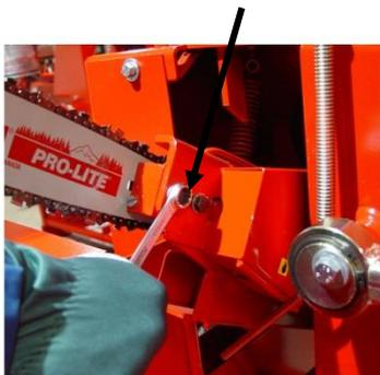
**Tension correcte de la chaîne:** En tirant la chaîne, une dent reste visible à l'arête inférieure, et après avoir tendu, la chaîne est serrée dans le guide sur son arête inférieure.
