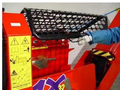
**IMPORTANT!** S'il est possible d'ouvrir le couvercle de la goulotte de fendage lorsque le levier de fendage est en position IN OPERATION, il convient de ne pas utiliser la machine et de réparer le dispositif de verrouillage, cela signifie que l'ouverture du capot de la goulotte de fendage ne doit être possible que si le levier de fendage est en position STOP.
