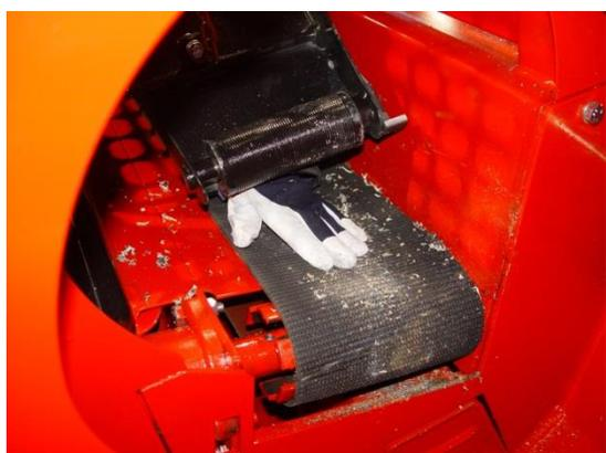
**FAITES** toujours **ATTENTION** au capot à ressort de l'ouverture de coupe. Ne mettez **JAMAIS** la main entre le bois et le rouleau lors du transfert du bois. **ATTENTION!** Ne mettez pas la main entre le rouleau de support et la table de coupe ou le convoyeur.
