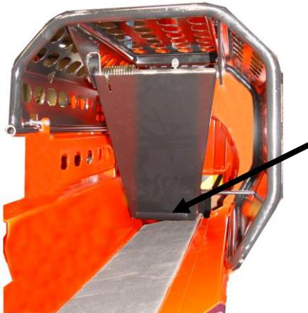
Le dispositif de manutention des rondins maintient les rondins dans la bonne position.
