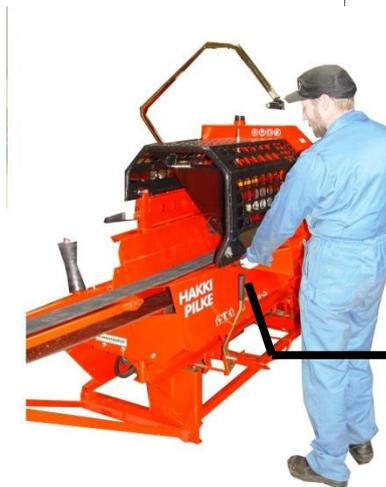
Tenir le levier en levant ou abaissant le couvercle de protection du convoyeur d'alimentation !
