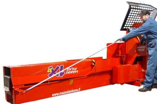
4. Abaissez le convoyeur avec le treuil jusqu'à la position horizontale.
