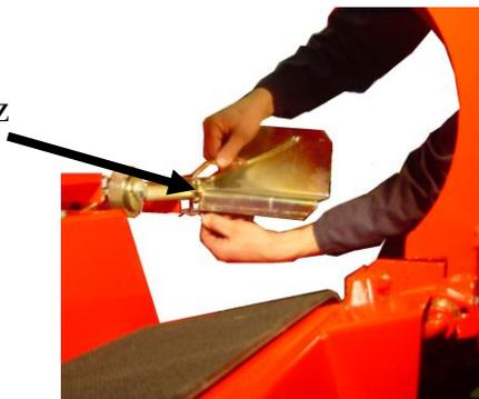
**N.B. : Si le diamètre du bois est supérieur à 30 cm, placez le limiteur sur !!!!**
