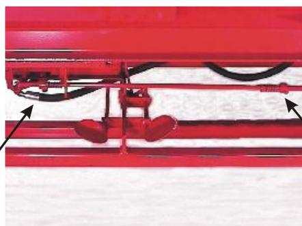
Le mouvement de retour du tube de fendage, c'est-à-dire la distance à laquelle le tube s'approchera de la lame lors du mouvement de fendage, se règle en déplaçant la butée vers la droite.
