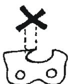
2. La jauge de profondeur de la tronçonneuse est trop grande, elle devrait être de 0,65 mm.
