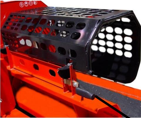
**En ouvrant le couvercle de protection du convoyeur d'alimentation vous assurer que le levier de blocage verrouille le couvercle dans sa position supérieure !**
