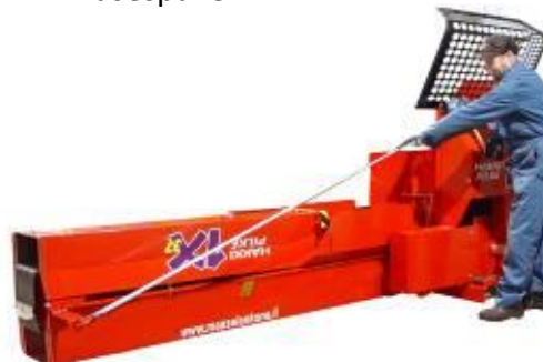
2. Skyv transportøren mot maskinen og frigjør låsingen av transportøren ved å løfte opp låsespaken
