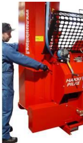
2. Skyv transportøren mot maskinen og frigjør låsingen av transportøren ved å løfte opp låsespaken
