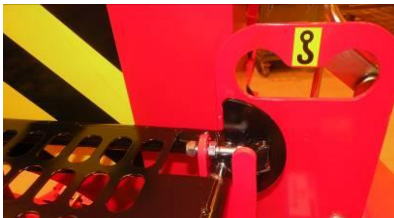
Bilde 4. Maskinens løftepunkter for kjetting eller løfteliner.
