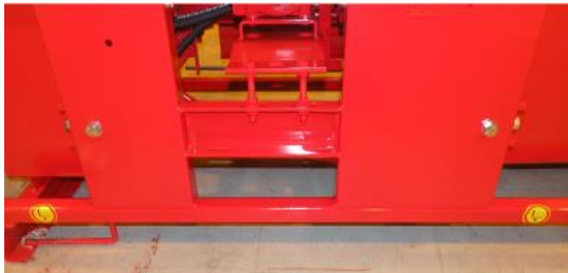
Bilde 3. Maskinens løftepunkter for truckgaffer.
