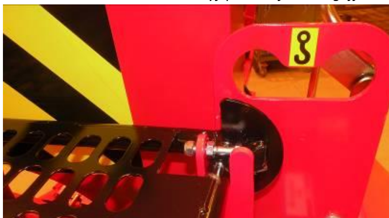
Bild 4. Maskinens lyftpunkter för kedja eller lyftlinor.
