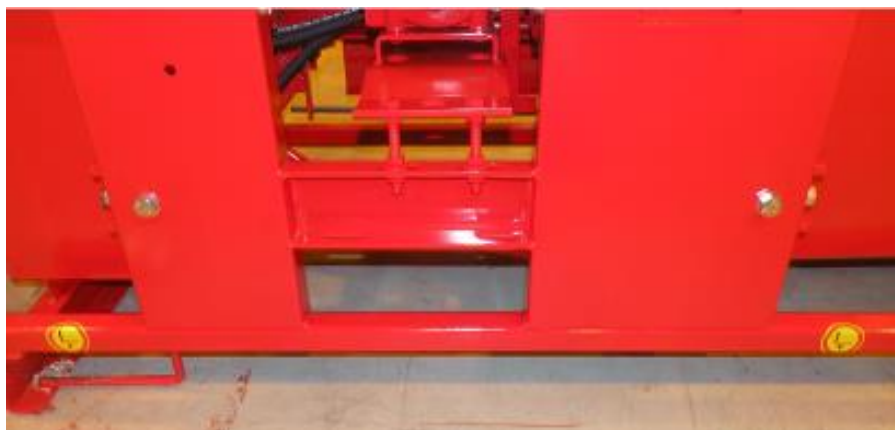
Bild 3. Maskinens lyftpunkter för truckgafflar.
