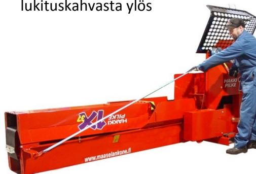
2. Työnnä kuljetinta koneeseen päin ja vapauta kuljetin lukituksestaan nostamalla lukituskahvasta ylös
