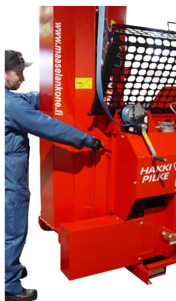
2. Työnnä kuljetinta koneeseen päin ja vapauta kuljetin lukituksestaan nostamalla lukituskahvasta ylös
