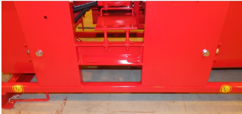
Kuva 3. Koneen nostokohdat trukkipiikeille.
