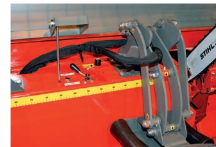
AC 10 automaattinen ketjunkiristin pitää teräketjun aina optimaalisella kireydellä. Ketjun voi vaihtaa kätevästi löysäämällä teräketjun kuvan vipua kääntämällä - ilman työkaluja!
