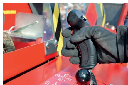
Sahauksen ja halkaisun sähköinen ohjaus vain kahdella napilla.
