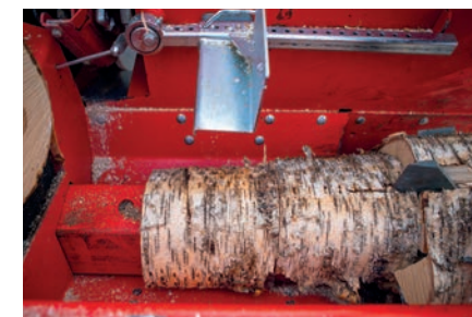
38 Pro:ssa on puoli-isku toiminto, joka tekee lyhyitä polttopuita nopeasti. Puoli-isku toimintoa voidaan hallita helposti painikkeella etupaneelistä.
