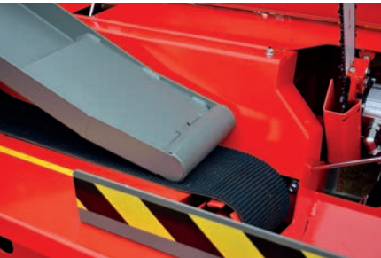
Puunsyöttö karheapintaisella ja raskastakin käyttöä kestävällä matolla.
