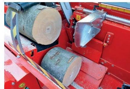
Ohjauslevyjen avulla lyhyimmätkin puut putoavat hallitusti halkaisukouruun.
