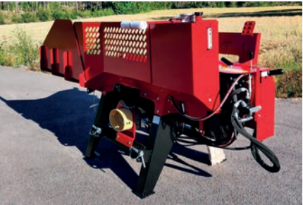
Hakki Pilke HH 110 OH hydraulihalkoja omalla hydraulikalla, jonka suositeltu tuotto on 400 r/min, 37 l/min.
