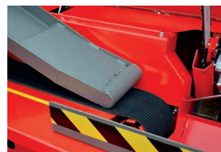
Puunsyöttö karheapintaisella ja raskastakin käyttöä kestäväällä matolla.
