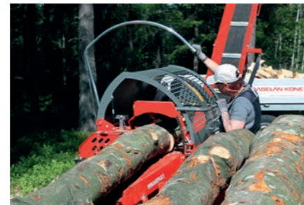
Koneen suoraohjattu hydraulikka mahdollistaa yhtäaikaiset toiminnot kevyillä kammien liikkeillä.
