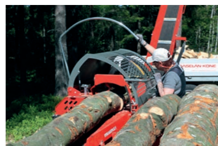
Hydraulika s přímým pohonem stroje umožňuje ovládat souběžné funkce snadnými pohyby ovládací páky.
