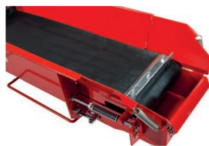
Patentované čistící zařízení na vykládacím dopravníku ve standardu. Drážka na konci vykládacího dopravníku slouží k odstranění třísek a zbytků.
