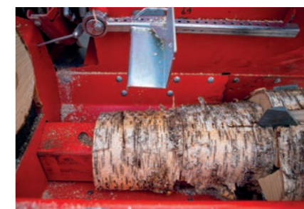
38 Pro má funkci polovičního štípaní, která urychluje štípaní krátkého palivového dřeva. Funkci polovičního štípaní lze snadno ovládat tlačítkem na předním panelu.
