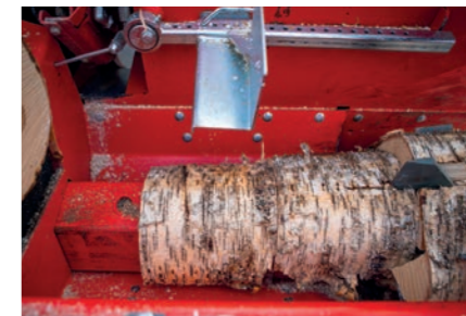
Die Halbhubfunktion des 38 Pro beschleunigt den Spaltvorgang von Kurzholz. Die Halbhubfunktion lässt sich bequem über eine Taste am Bedienfeld steuern.
