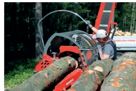
Die Direktantriebshydraulik der Maschine ermöglicht mit dem flexiblen Bedienhebel die Bedienung mehrerer Funktionen gleichzeitig.
