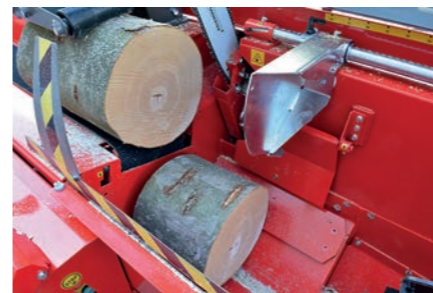
Die Scheit-Auffangbleche stellen sicher, dass auch die kürzesten Scheite korrekt in die Spaltkehle gelangen.
