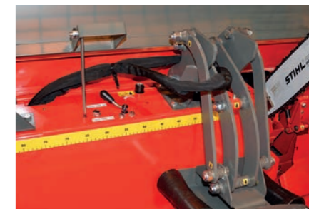
Der automatische Kettenspanner AC10 sorgt dafür, dass die Kette immer optimal gespannt ist. Die Kette kann bequem ausgetauscht werden, nachdem die Kettenspannung mit dem abgebildeten Hebel gelöst wurde – keine Werkzeuge erforderlich!
