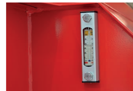
Öltank mit großer Kapazität und Schauglas.
