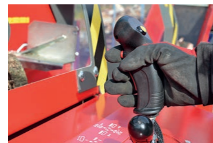
Elektrische Steuerung von Schneiden und Spalten mit nur zwei Tasten.
