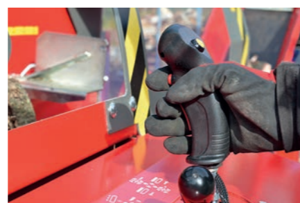
Contrôle électrique du sciage et du fendage via deux simples boutons.
