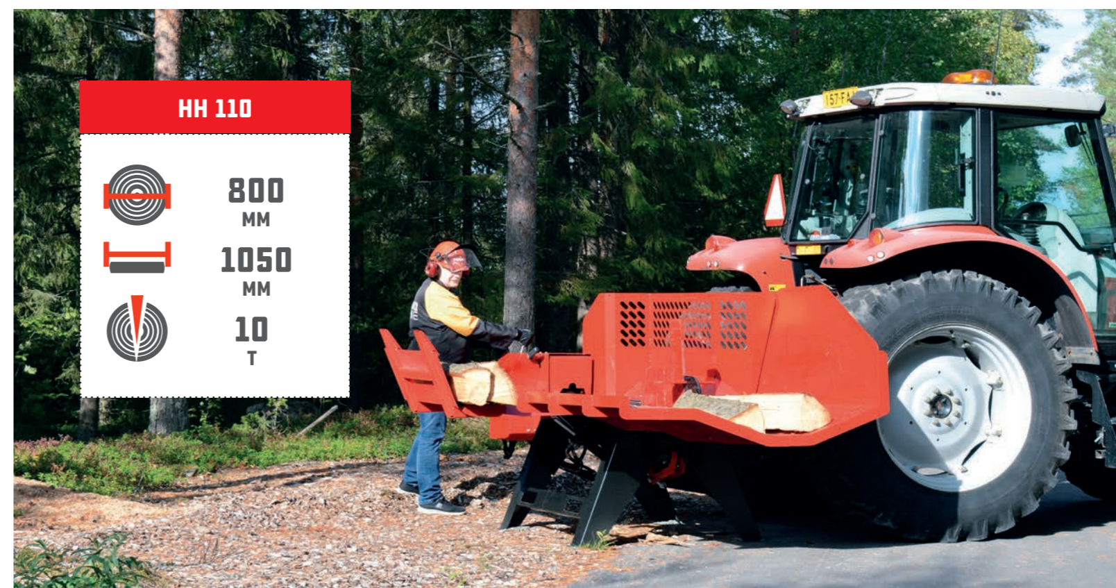
En modifiant la hauteur de la lame de coupe, il est possible de fendre la bûche en deux ou quatre morceaux.
