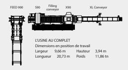
Diamètre de bûche maximal 90 cm \*Optimal 70-80 cm Longueur de bûche 20-45 cm \*Optimal 20-33 cm Puissance de fendage 47 tn
