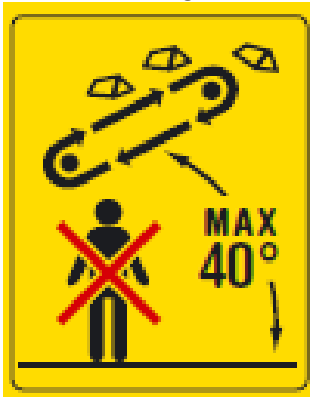
Maximaler Schwenkwinkel des Förderers: 40° Halten Sie sich nicht unter dem Förderer auf.
