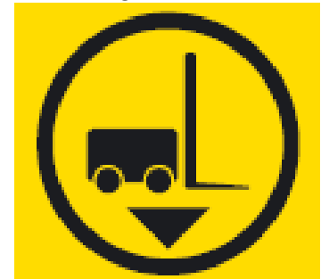
Endroit de levage de la machine sur le chariot élévateur
