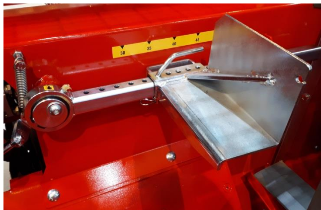
Afbeelding 15: positie van meetinrichting voor grote houtblokken met een doorsnede van meer dan 25 cm.
