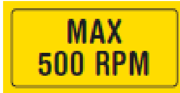
De maximale snelheid van de aandrijfjas is 500 rpm.
