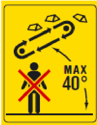
De maximaal toegestane hoek van de transportband is 40°. Loop niet onder de transportband.
