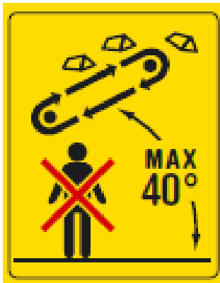
Transportörens maximala driftvinkel 40° Gå inte under transportören
