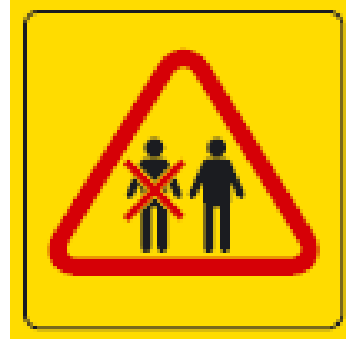
Maskinen får endast användas av en person
