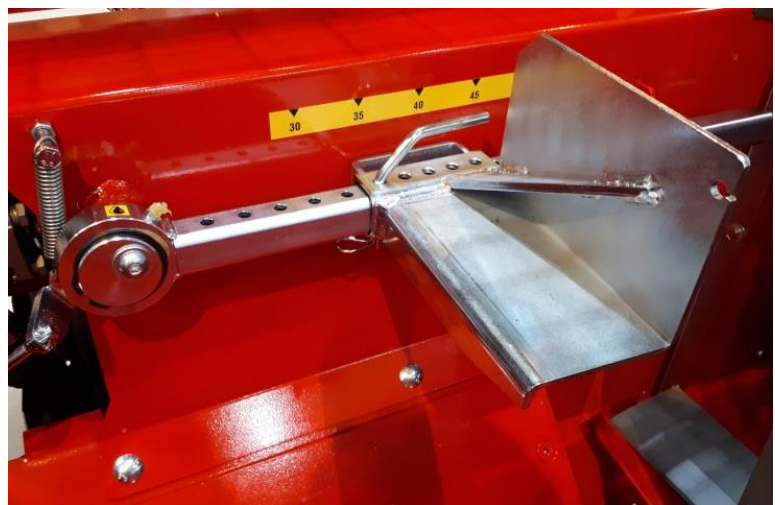
Abb. 15: Position des Messgeräts für großes Holz mit einem Durchmesser über 25 cm.
