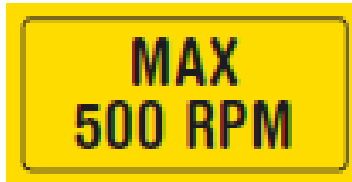
Макс. число оборотов карданного вала 500 об/мин
