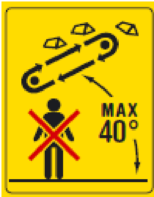
Максимальный рабочий наклон транспортера – 40 ° Под конвейером не ходить
