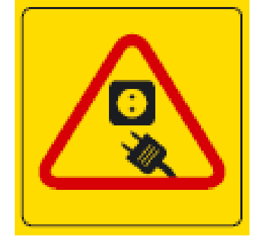
Koppla från maskinens strömtillförsel före serviceåtgärder
