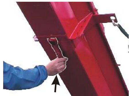
7. Justera transportören till önskad lutning med vinschen och lås förlängningen med låset i transportörens botten
