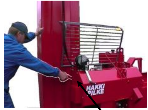
3. Skjut transportören mot maskinen och frigör transportörens låsning genom att lyfta upp låsspaken
