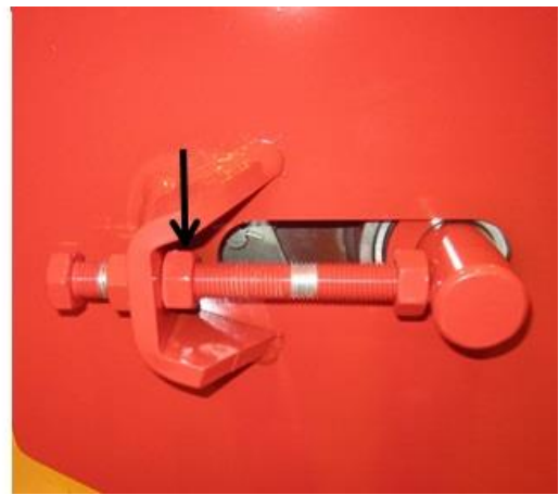
Joonis 4 (nool vasakul: pingutamine, nool paremal: lukustamine)
