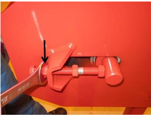
Joonis 4 (nool vasakul: pingutamine, nool paremal: lukustamine)
