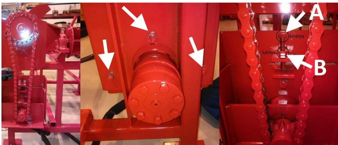
Joonis 5 (Mootori keti pingutamine)
