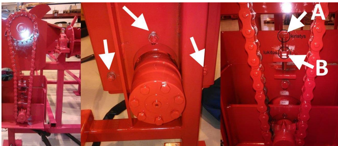
Рис 5 (Натяжение цепи двигателя)
