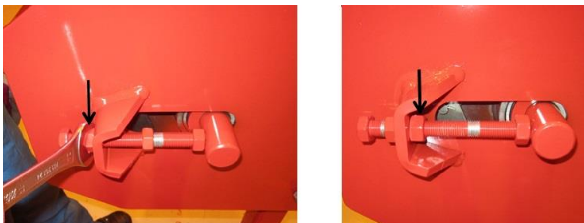
Рис 4 (стрелка слева: натяжение, Стрелка справа: фиксация)
